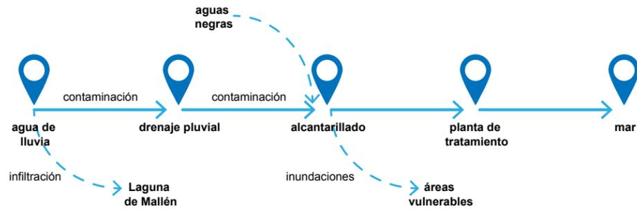
Figura 48. Diagrama del sistema lineal actual: agua lluvia
